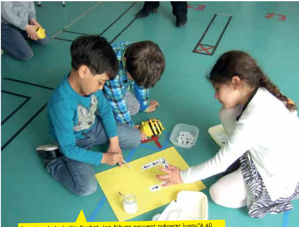
Avec le robot-abeille Beebot, les élèves peuvent préparer jusqu'à 40 déplacements et les entrer sur l'appareil en appuyant sur les boutons.
